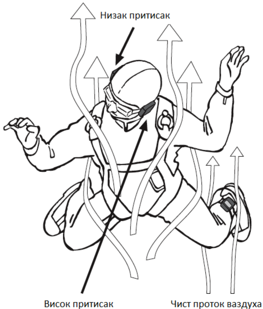
Слика 3. Приказ опструјавања ваздуха током слободног пада
